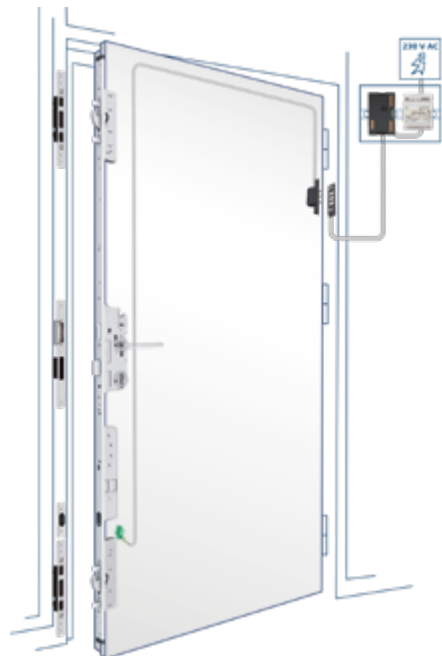
Récepteur multifonction et transformateur 12V sur rail DIN dans coffret électrique
