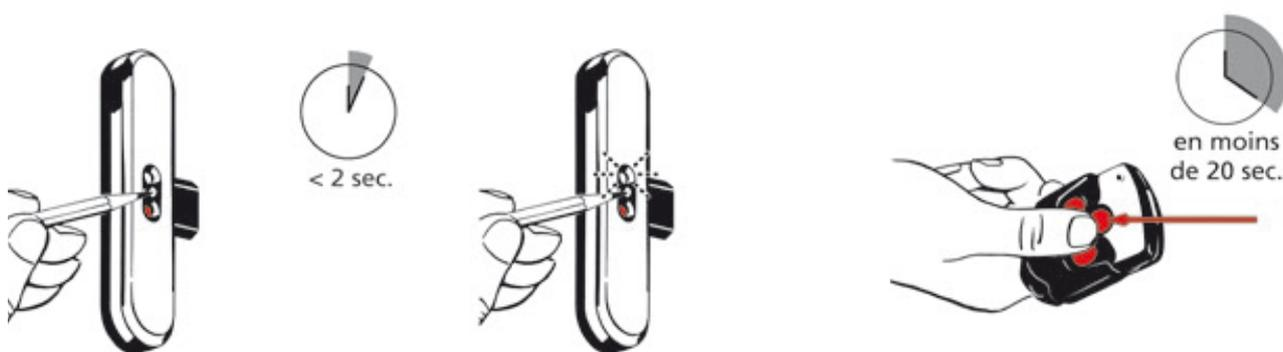
2. Fermer la porte et appuyer **brèvement (moins de 2 secs.)** sur la touche de programmation entre le LED rouge et le LED vert du récepteur à l'aide d'un objet fin (un stylo ou un crayon etc.).
