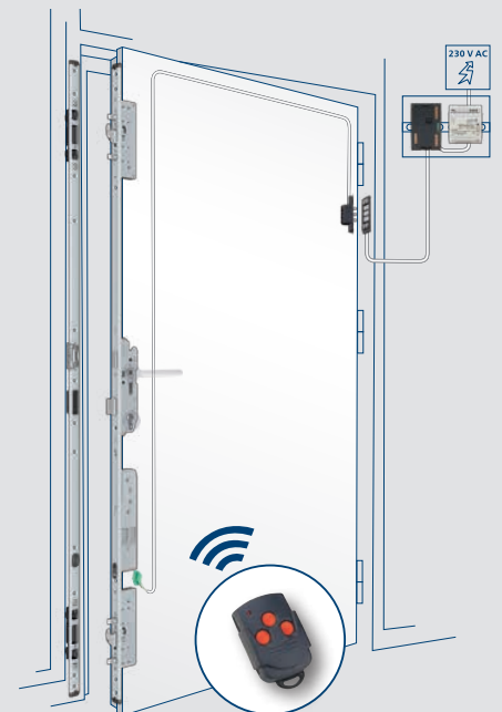
Steuerung und Netzteil zur Hutschienen-Montage im Schaltschrank
