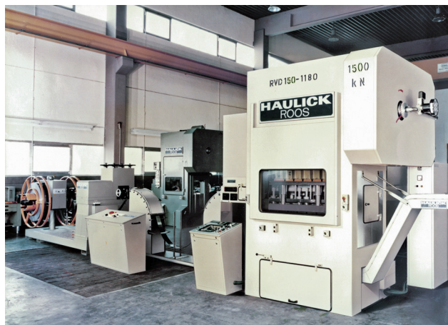
Moderner Stanzautomat aus dem Jahr 1984
